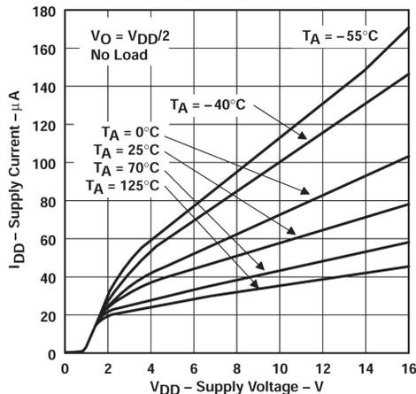
図 5-19. 電源電流と電源電圧との関係
