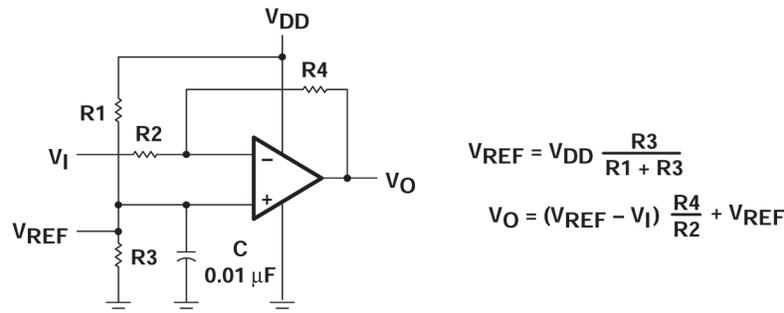
図 7-1. 反転アンプと電圧リファレンス
