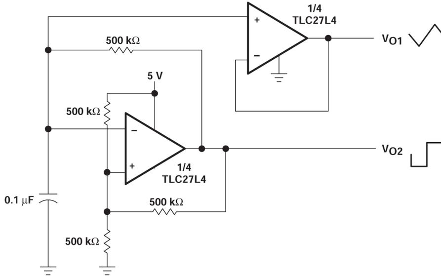
図 7-9. マルチバイブレータ
