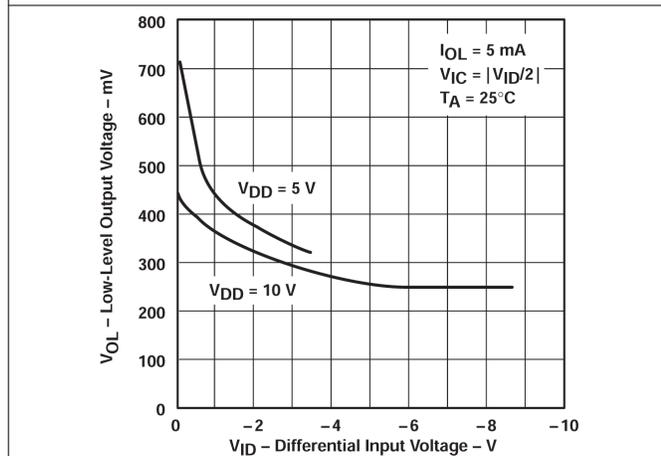
図 5-11. Low レベル出力電圧と差動入力電圧との関係
