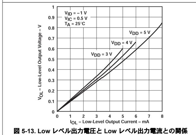
図 5-13. Low レベル出力電圧と Low レベル出力電流との関係
