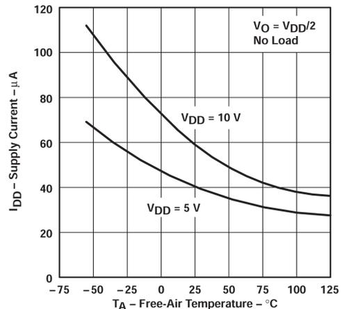
図 5-20. 電源電流と自由気流温度との関係
