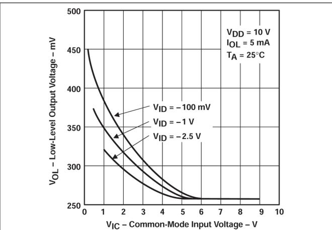
図 5-10. Low レベル出力電圧と同相入力電圧との関係
