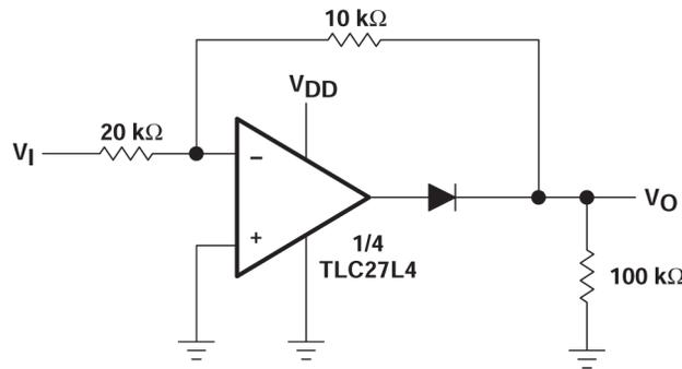
図 7-12. 全波整流器、 $V_{DD} = 5V \sim 16V$
