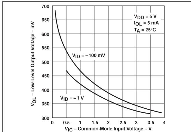
図 5-9. Low レベル出力電圧と同相入力電圧との関係
