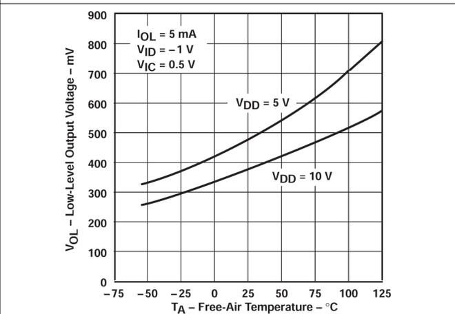
図 5-12. Low レベル出力電圧と自由気流温度との関係
