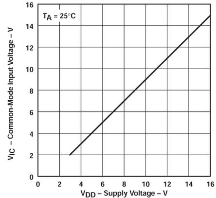
図 5-18. 同相モードの入力電圧の正の制限と電源電圧との関係
