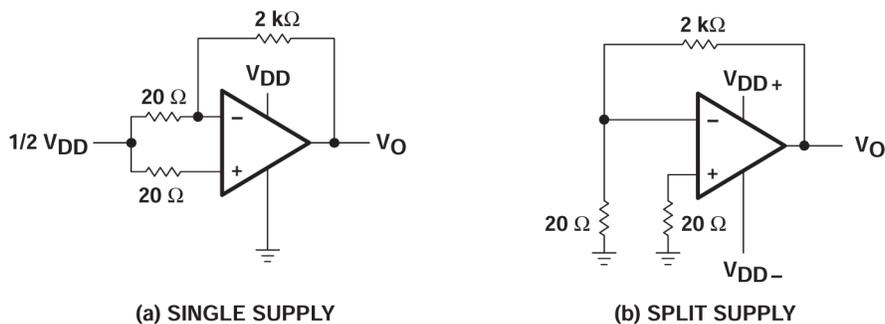
図 6-2. ノイズ テスト回路
