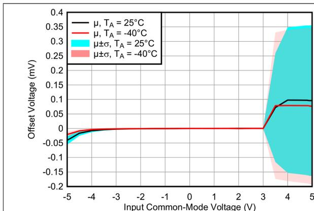
図 7-3. オフセット電圧 対 入力同相電圧
