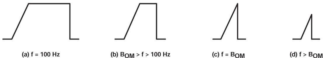
図 6-5. 最大出力応答の出力信号
