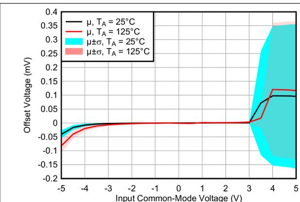
図 7-4. オフセット電圧 対 入力同相電圧
