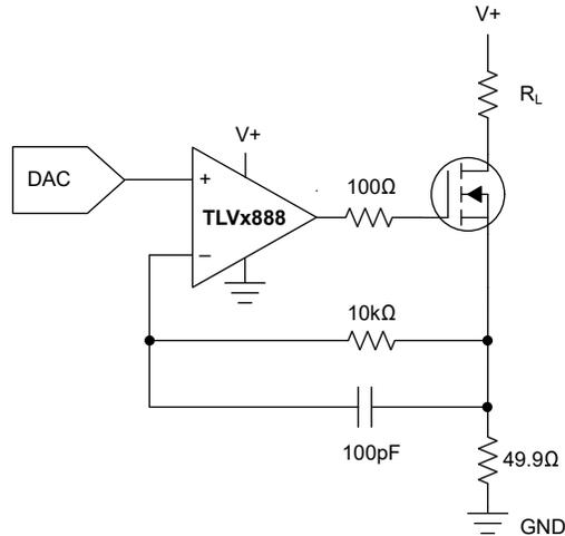
図 7-6. プログラマブル、高精度電流源
