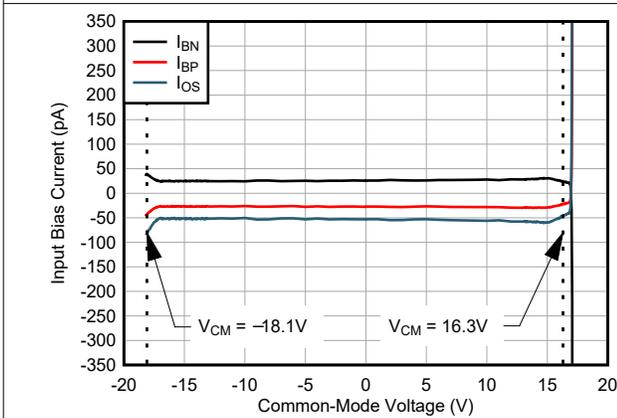
図 5-11. 入力バイアス電流と同相電圧との関係
