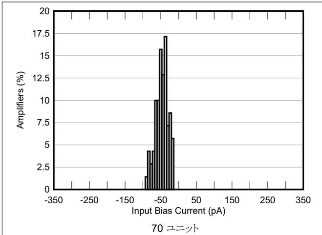
図 5-5. 入力バイアス電流の分布、 $I_{BP}$
