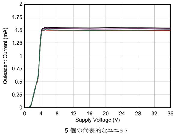
図 5-25. 静止電流と電源電圧との関係
