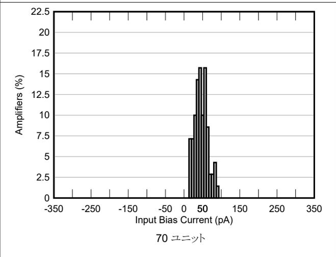
図 5-4. 入力バイアス電流の分布、 $I_{BN}$
