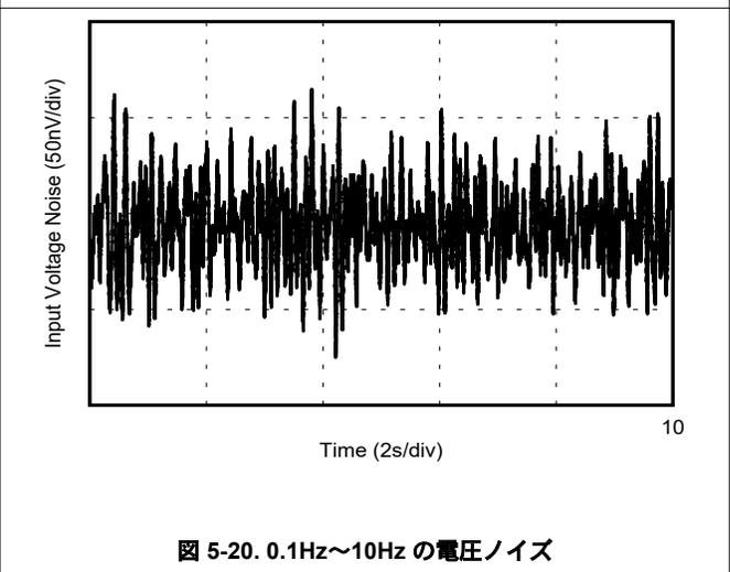
図 5-20. 0.1Hz~10Hz の電圧ノイズ
