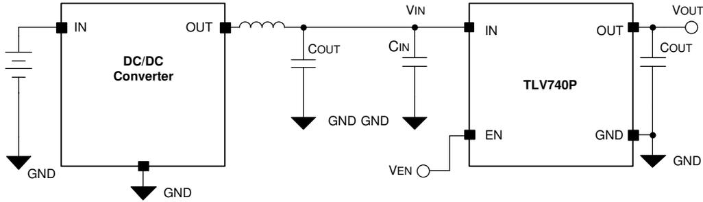
図 7-5. DC/DC コンバータからの動作
