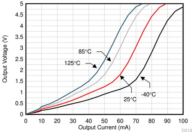
$V_S = 5\text{V}$ ,  $R_L$  を  $V_+$  に接続
