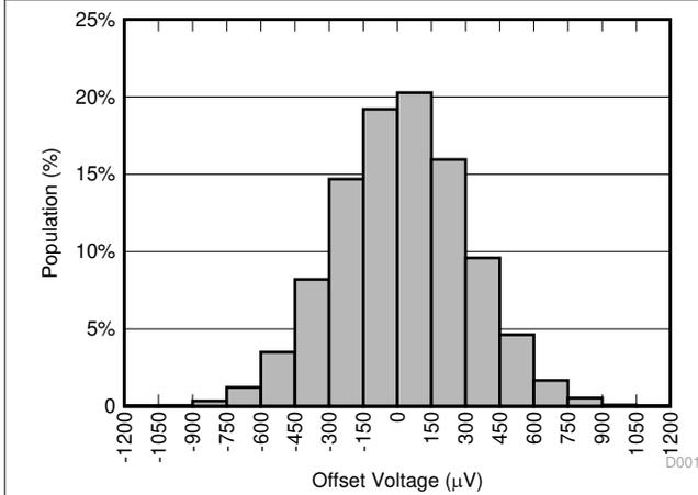
13,481 個のアンプにおける分布、 $T_A = 25^\circ\text{C}$
