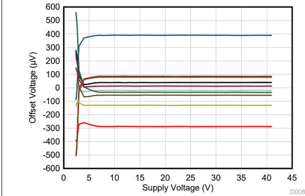
図 6-9. オフセット電圧と電源電圧との関係
