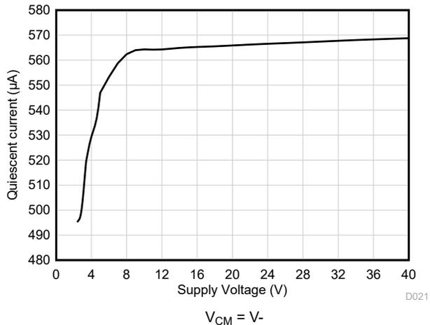
図 6-23. 静止電流と電源電圧との関係
