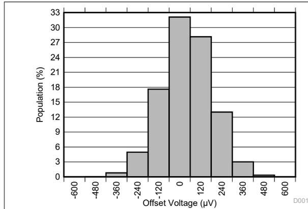
15462 個のアンプにおける分布、 $T_A = 25^\circ\text{C}$
