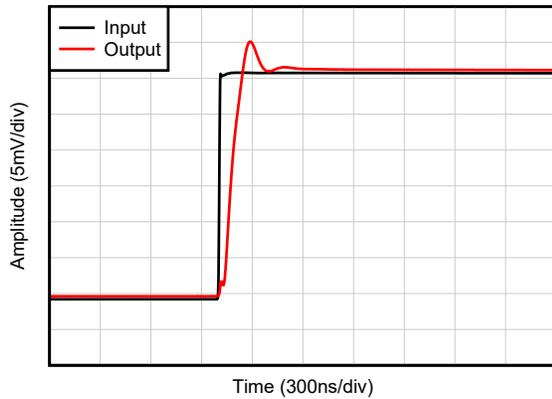
$C_L = 20\text{pF}$ ,  $G = 1$ , 20mV ステップ応答
