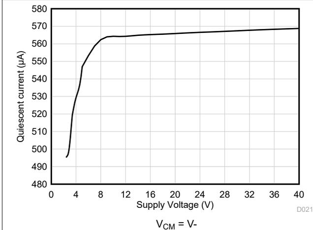
図 5-23. 静止電流と電源電圧との関係
