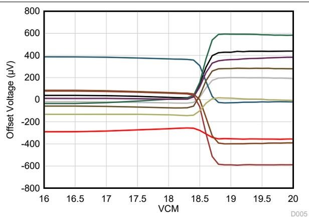
図 5-6. オフセット電圧と同相電圧との関係 (遷移領域)
