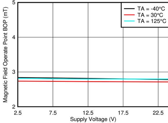
图 7-51. B<sub>OP\_Y</sub> Threshold vs. V<sub>CC</sub>
