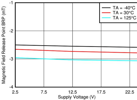
图 7-53. B<sub>RP\_Y</sub> Threshold vs. V<sub>CC</sub>
