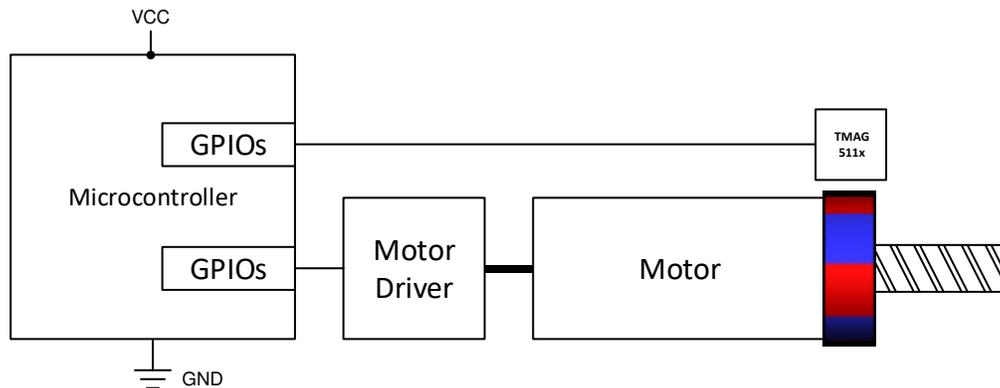
図 9-1. Incremental Encoding
