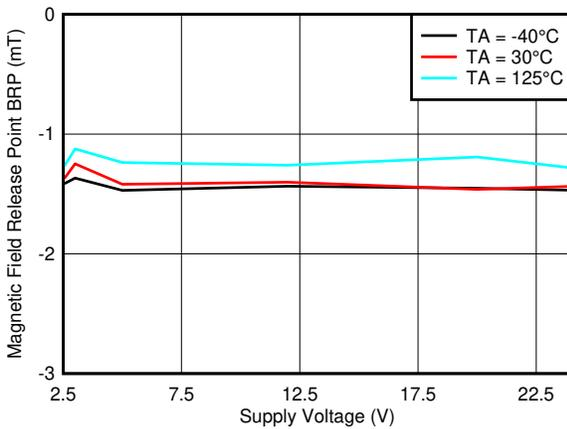
7-9. B<sub>RP\_X</sub> Threshold vs. V<sub>CC</sub>
