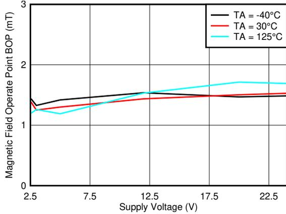
7-7. B<sub>OP\_X</sub> Threshold vs. V<sub>CC</sub>
