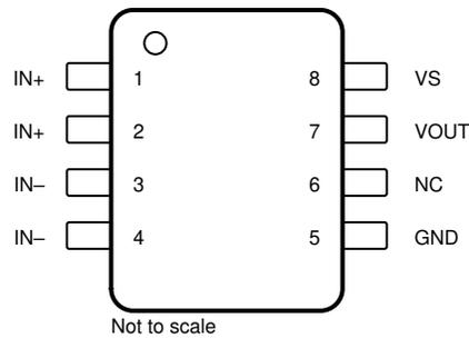
図 6-1. D パッケージ 8 ピン SOIC 上面図
