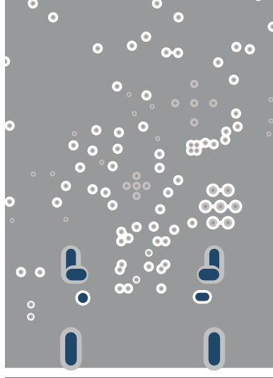
図 7-9. TPS26750 PCB Layout - GND Layer 5
