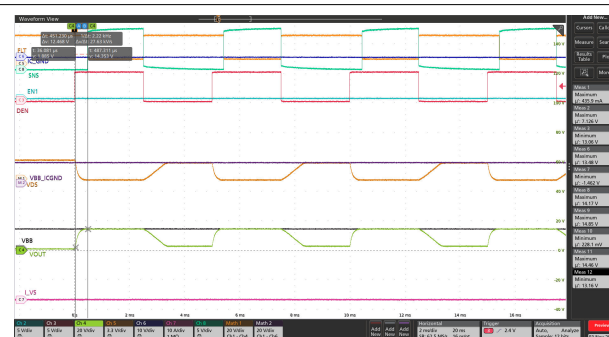
図 9-8. 立ち下がりスルーレート (P、M バージョン)
