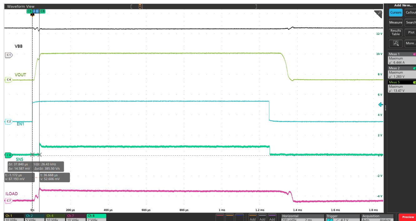
図 8-6. EN による SNS 応答時間 ( t_{SNSION3} )
