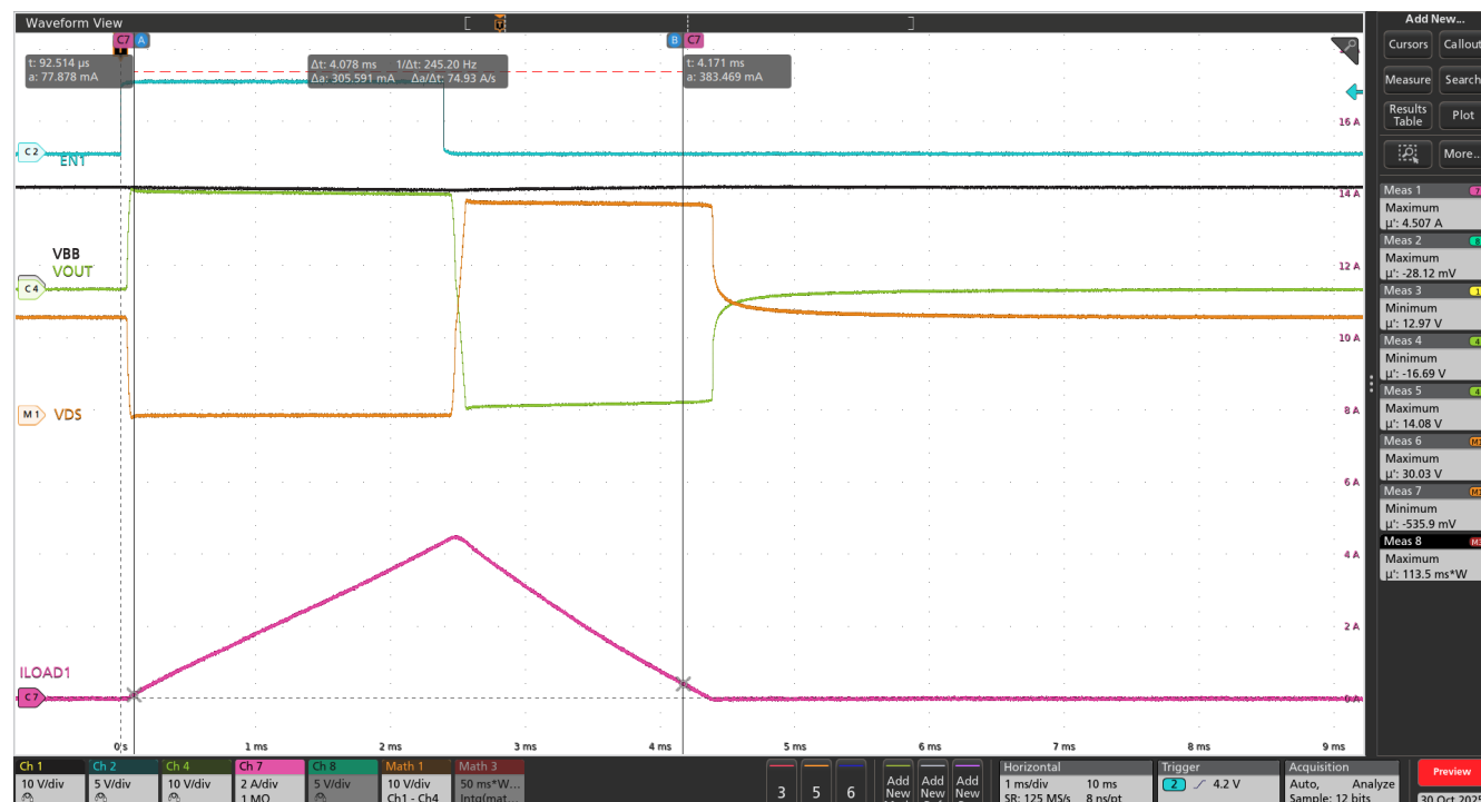
図 8-25. 5mH 誘導性負荷ドライブ (VBB = 13.5V、T AMB = 125°C)
