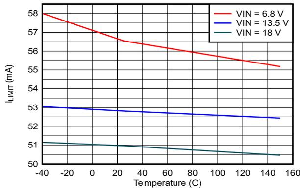
図 6-11. LDO\_3V3 Current Limit vs  $V_{IN}$  and Temperature
