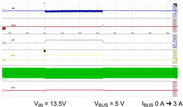
図 9-30. Load Transient (Buck):  $V_{BUS} = 5\text{ V}$
