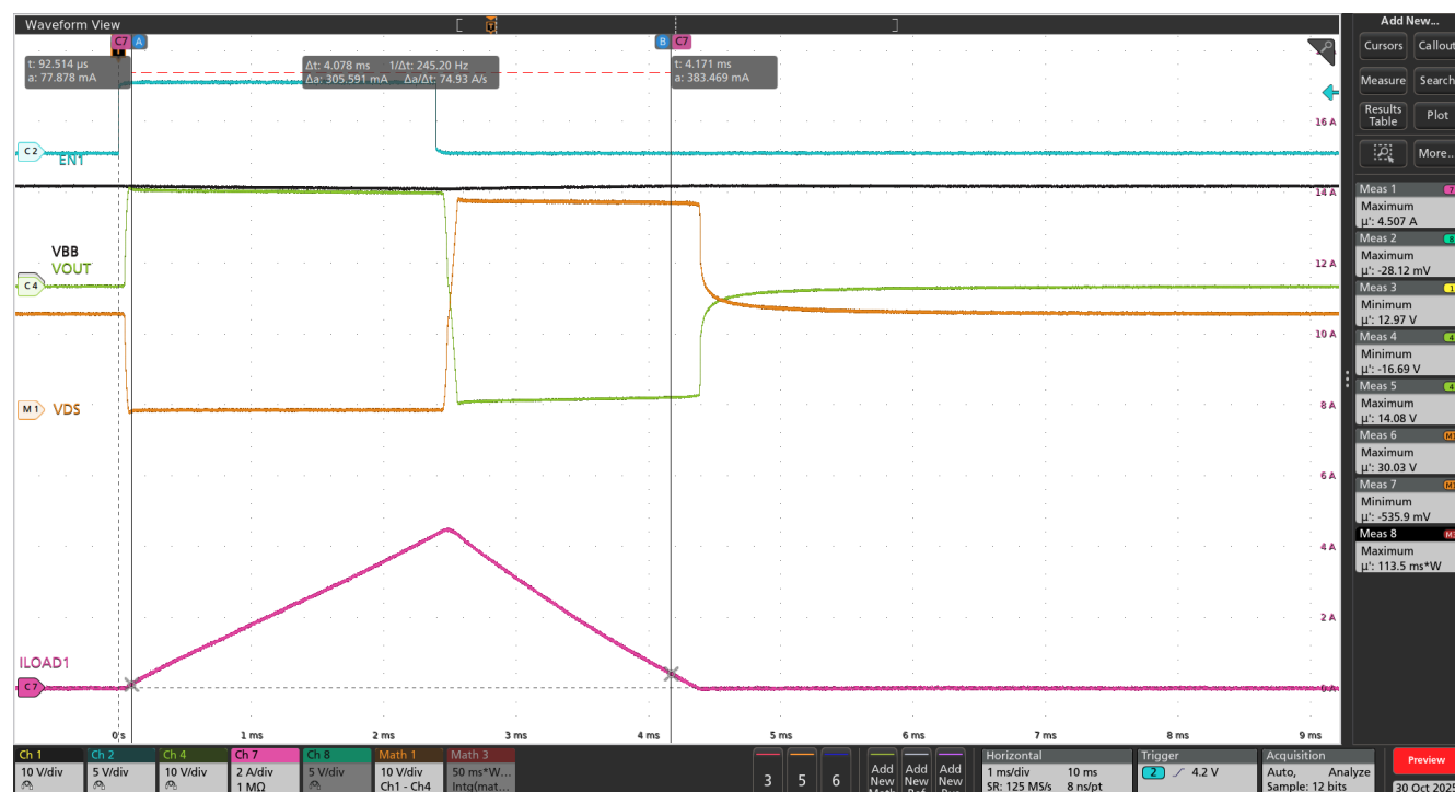
図 8-27. 5mH 誘導性負荷ドライブ (VBB = 13.5V、 T_A = 25°C)
