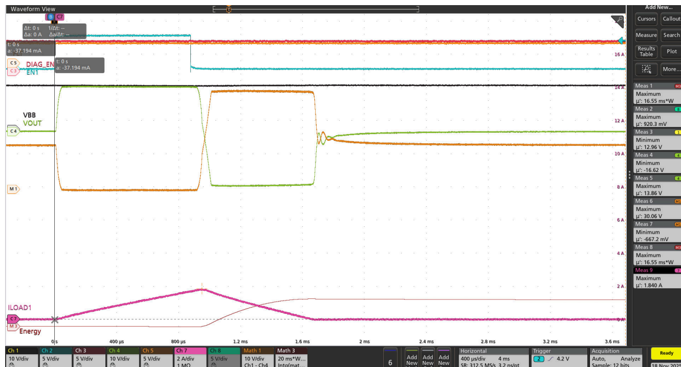
図 8-26. 5mH 誘導性負荷ドライブ (VBB = 13.5V、T AMB = 125°C)
