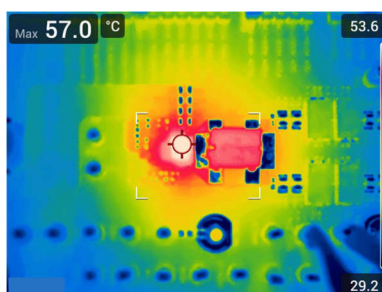
図 8-7. 熱特性、800kHz FCCM、外部 5V バイアス、25A 負荷
