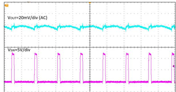
図 7-5. 出力電圧リップル、I<sub>OUT</sub> = 12A、時間 = 1µs/div
