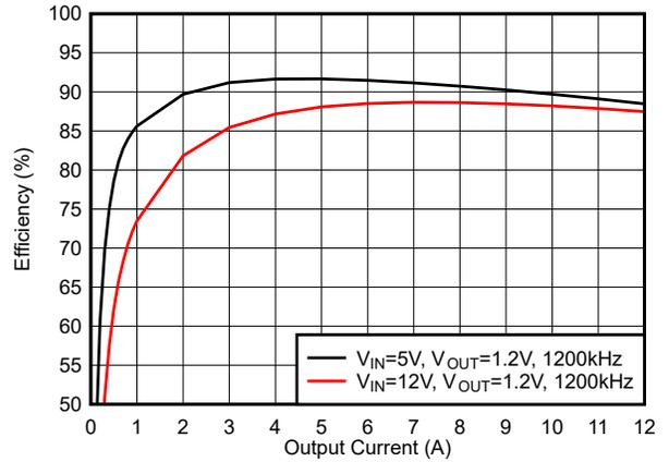
図 5-14. 効率 : FCCM モード、 $f_{sw} = 1200\text{kHz}$
