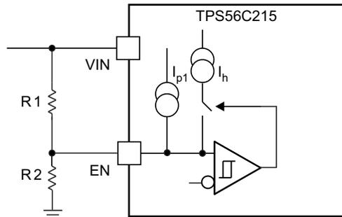
図 6-3. 可変の VIN 低電圧誤動作防止
