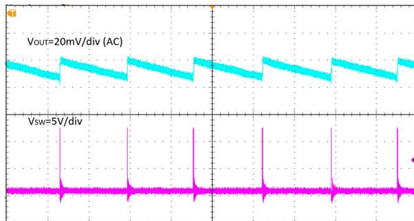
図 7-4. 出力電圧リップル、I<sub>OUT</sub> = 10mA、時間 = 80µs/div
