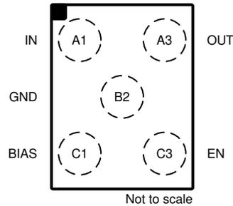
图 5-2. YKA Package, 5-Pin DSBGA, Top View
