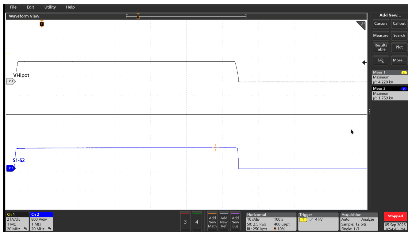
図 9-12. V HIPOT = 4000V でのアバランシェ電圧 (V S1-S2 ) (3126kΩ の制限抵抗を使用)
