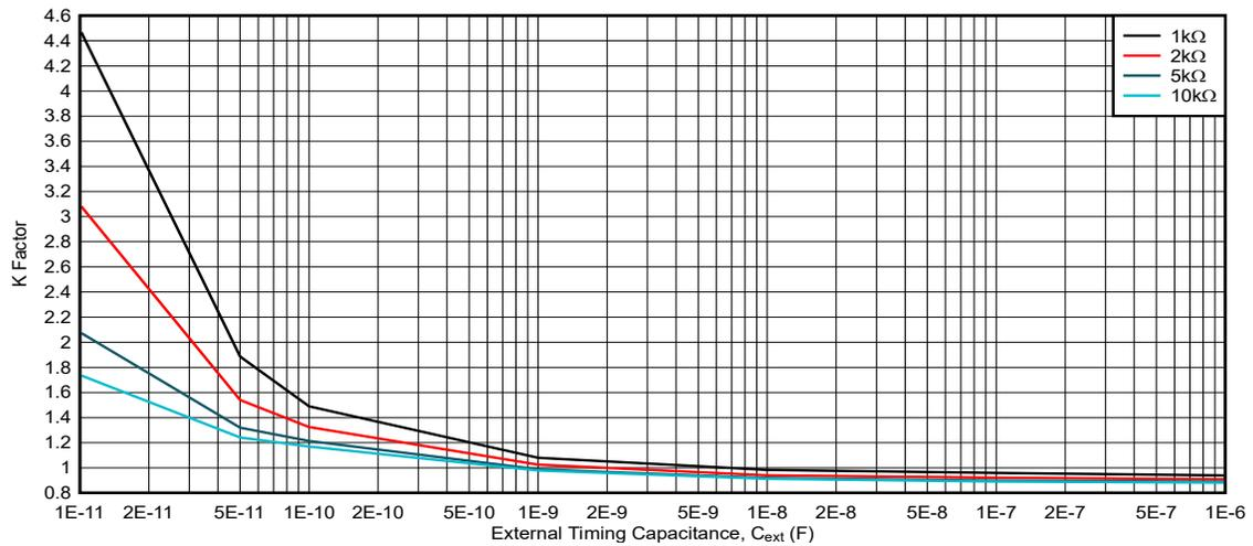
図 5-16. K 係数、 $V_{CC} = 5V$ 、 $R_{ext} = 1k\Omega \sim 10k\Omega$
