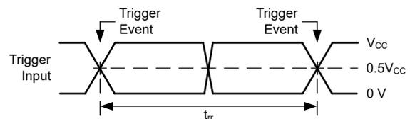
図 6-6. 電圧波形、リトリガ時間
