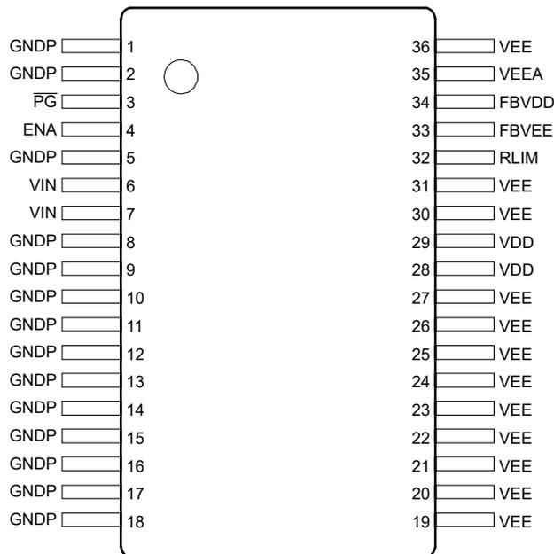
图 6-1. DWN Package, 36-Pin SSOP (Top View)
