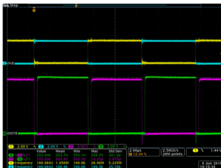
図 8-5. INA/B と OUTA/B のベンチ テスト波形
