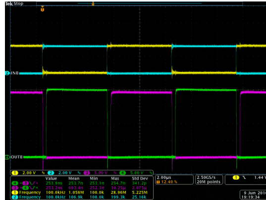
図 8-5. INA/B と OUTA/B のベンチ テスト波形
