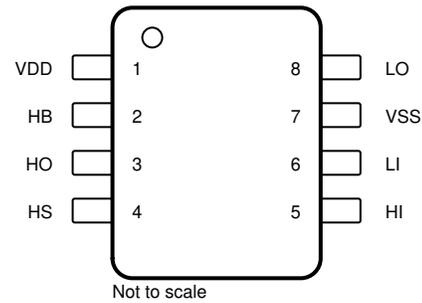
图 5-2. D Package 8-Pin SOIC Top View
