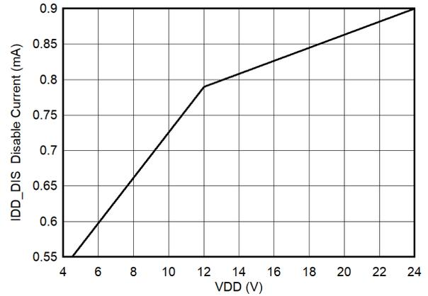
図 5-6. ディセーブル電流 (EN = 0V)
