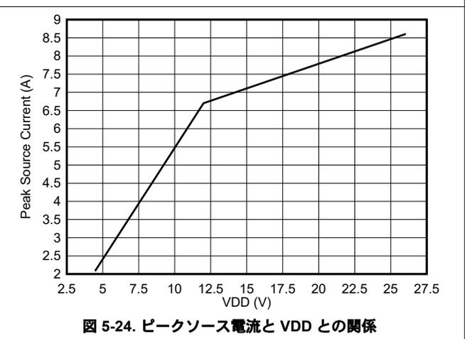
図 5-24. ピークソース電流と VDD との関係
