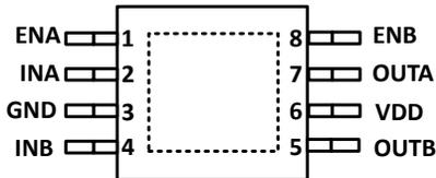
図 4-2. DGN パッケージ 8 ピン VSSOP 上面図
