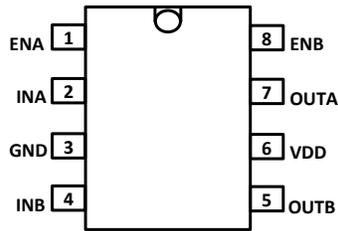
図 4-1. D パッケージ 8 ピン SOIC 上面図
