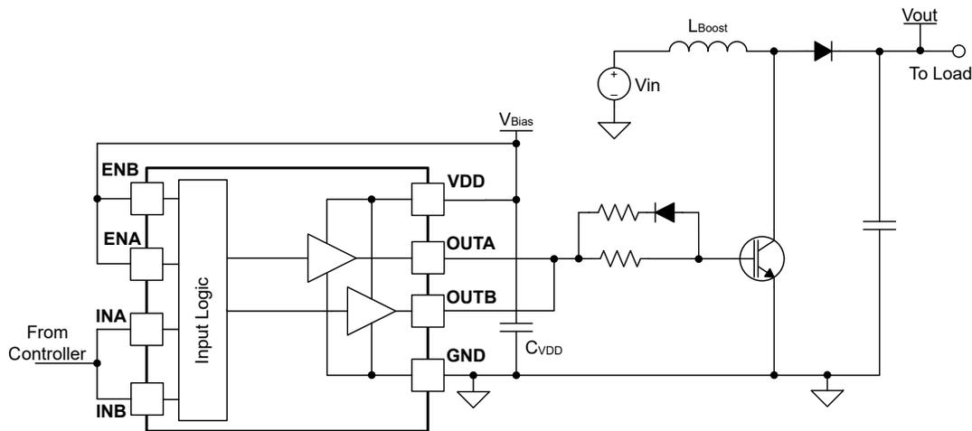
図 7-3. 昇圧コンバータの IGBT 駆動に使用されている UCC27624
