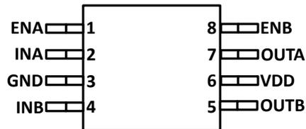
図 4-4. DGK パッケージ 8 ピン VSSOP 上面図
