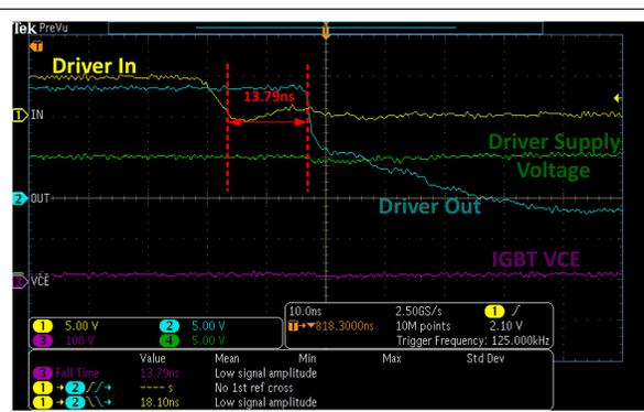
Vin = 210V、Vout = 235V、Iout = 1.14A、Fsw = 100kHz、ドライバ電源電圧 = 15V、ゲート抵抗 = 0Ω
