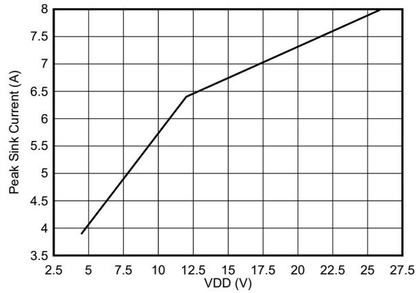
図 5-25. ピークシンク電流と VDD との関係
