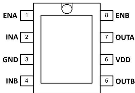
図 4-5. DDA パッケージ 8 ピン SOIC 上面図
