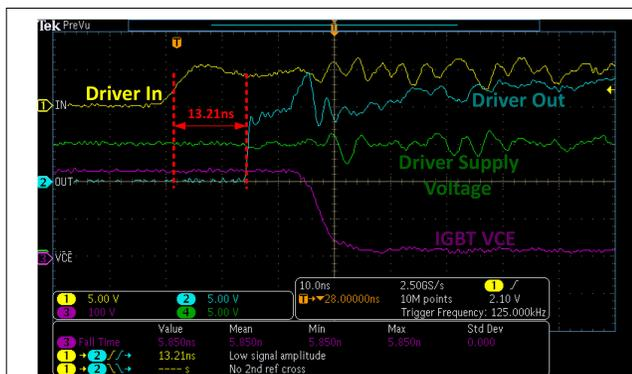
Vin = 210V、Vout = 235V、Iout = 1.14A、Fsw = 125kHz、ドライバ電源電圧 = 15V、ゲート抵抗 = 0Ω
