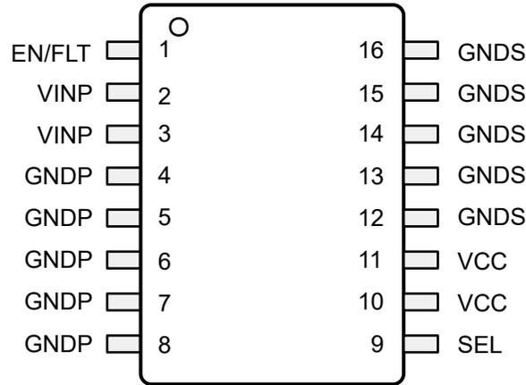
図 5-1. DHA SOIC 16-pin Package (Top View)
