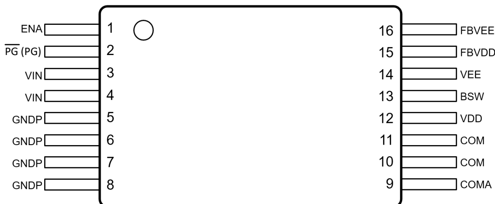
図 5-1. DHA パッケージ、16 ピン SSOP (上面図)
