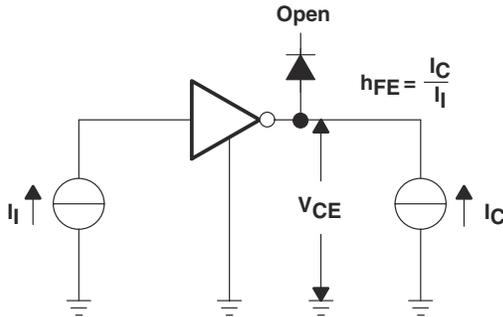
$I_I$  は  $V_{CE(sat)}$  の測定では固定、 $h_{FE}$  の測定では可変です。
