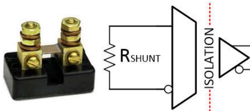
Abbildung 1. Isolierte shunt-basierte Strommessung
