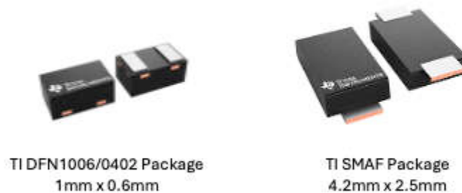
図 2-4. 小型の 0402 パッケージと大型の SMA-F パッケージの比較
