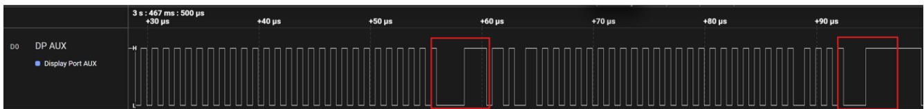
図 4-4. 極性のスワップ AUX トランザクション
