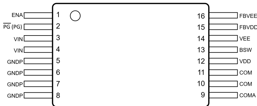
図 1-1. DHA パッケージ、16 ピン SSOP (上面図)
