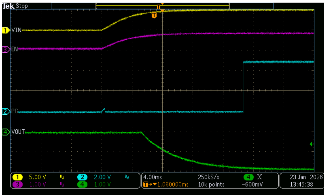
図 3-4. パワーグッド アサート — 抵抗デバイダ経由で EN を立ち上がり VIN に接続
