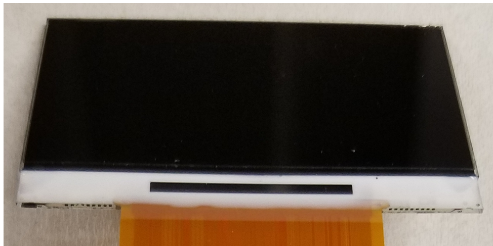
図 12. 太陽光テストで使用したTFTパネル。型番: E06030K16。
