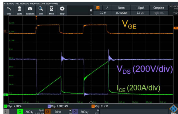
図 5-6. 0.5\Omega のゲート抵抗による強い駆動
