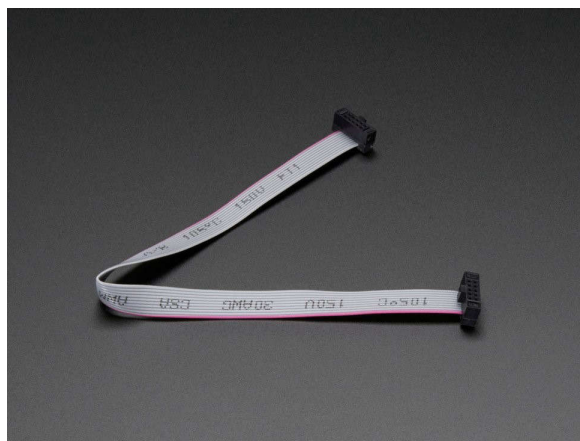
図 5-6. Arm 標準 10 ピン・ケーブル
