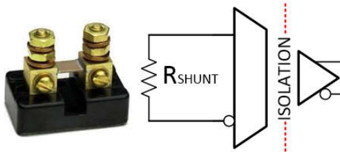
図 1. 絶縁型シャント方式電流検出
