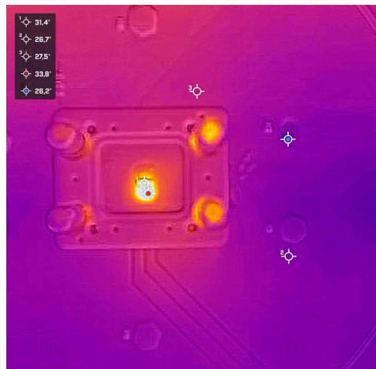
図 2-6. AMC038x の熱測定結果: 12.5mΩ
