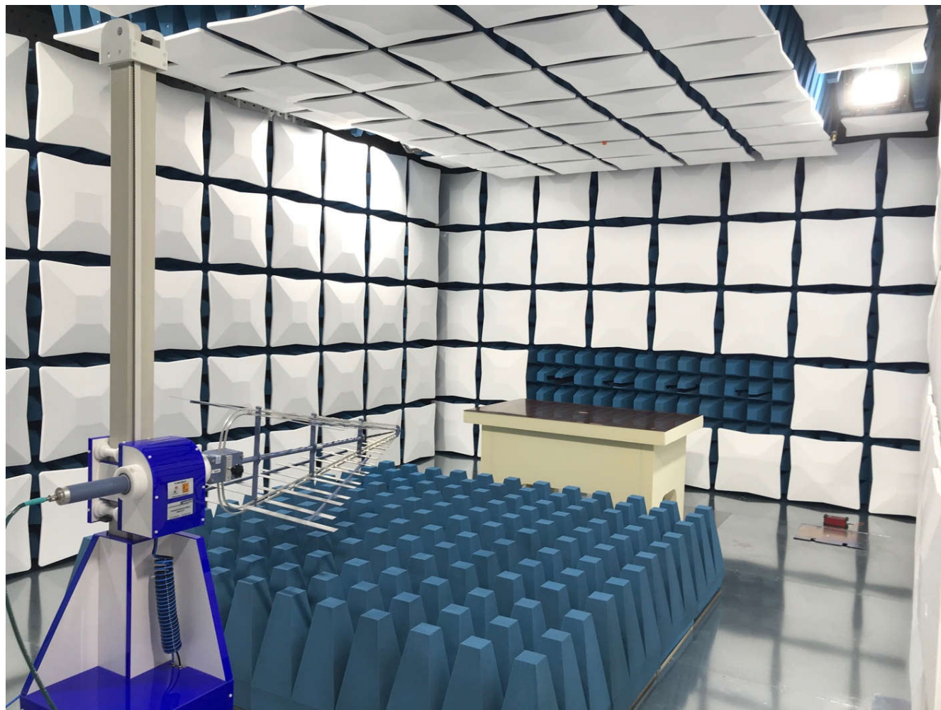
図 4-1. CISPR-32 のテストチャンバー設定
