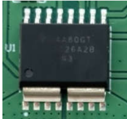
図 2-2. SOIC-16 フットプリント上の SOIC-10 パッケージ
