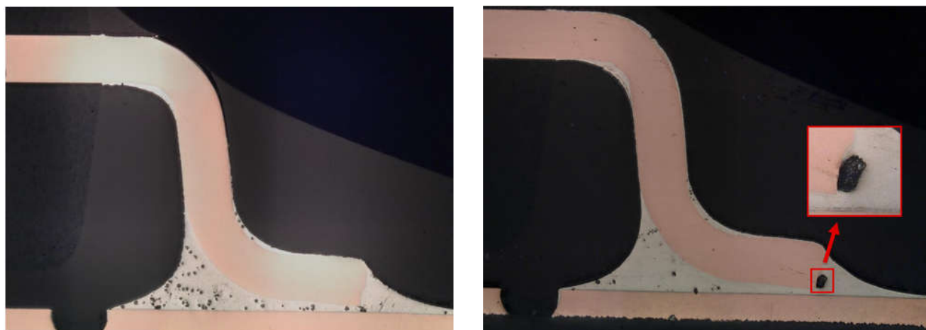
図 2-18. 断面図 — 500 回の温度サイクル
