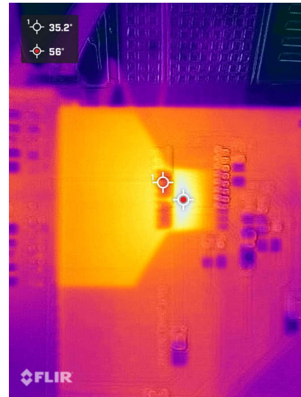
図 2-13. SOIC-16 フットプリント上の SOIC-10、ゼロ時間、SAC 水溶性ペースト
