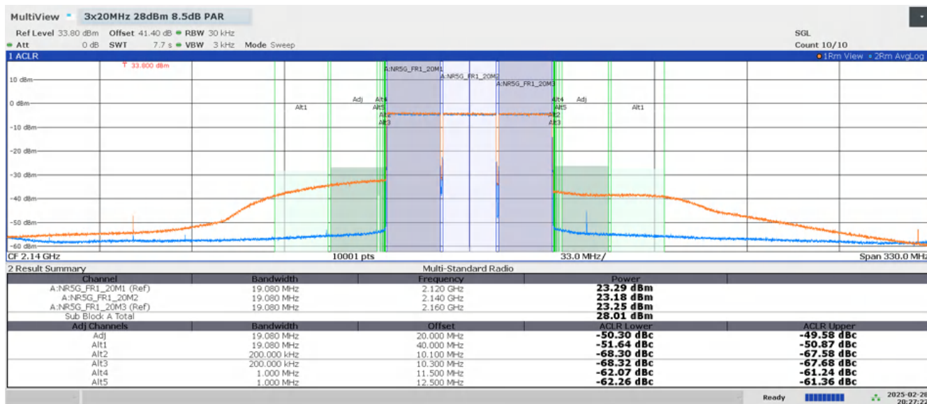
図 4-5. TX4 ACLR プロット: 2.140GHz の中心周波数で 3x20MHz の信号
