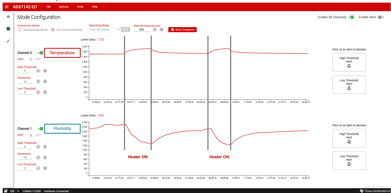
図 3-6. BOOSTXL-ADS7142-Q1 評価基板による HDC3120 の出力解釈
