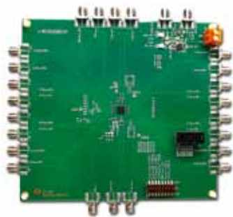
LMK00308EVM : 3GHz、8出力クロック・バッファ/ レベル・トランスレータの評価モジュール
