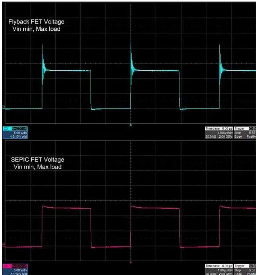
図 2. SEPIC FET の電圧リンギングはフライバックより小さいため、ストレスの低減と出力電圧レギュレーションの改善につながります
