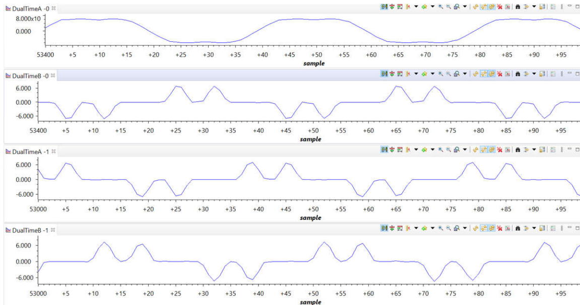
図 3-20. 検出された送電網電流 - PFC モード
