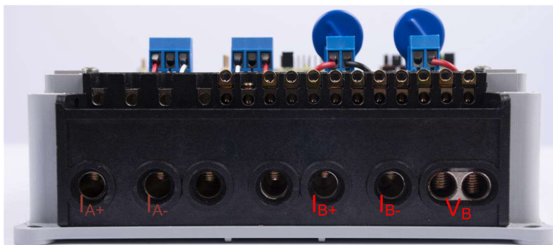
図 3-6. テスト設定の接続を含むリファレンス デザインの正面図、単一電圧構成
