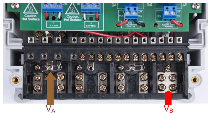
図 3-5. テスト設定の接続を含むリファレンス デザインの上面図、単一電圧構成
