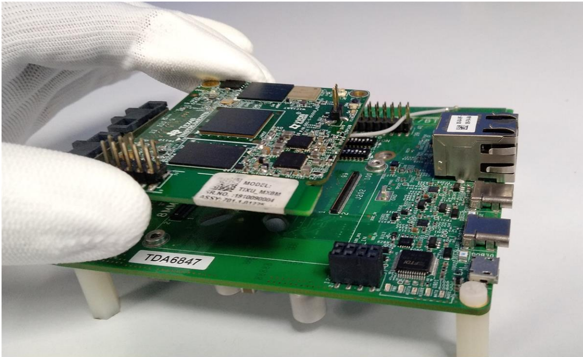
図 17. Screwing SoM Board to Base-board
