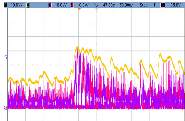
図 3-2. Class-H が動作している場合のオーディオ出力と昇圧電圧
