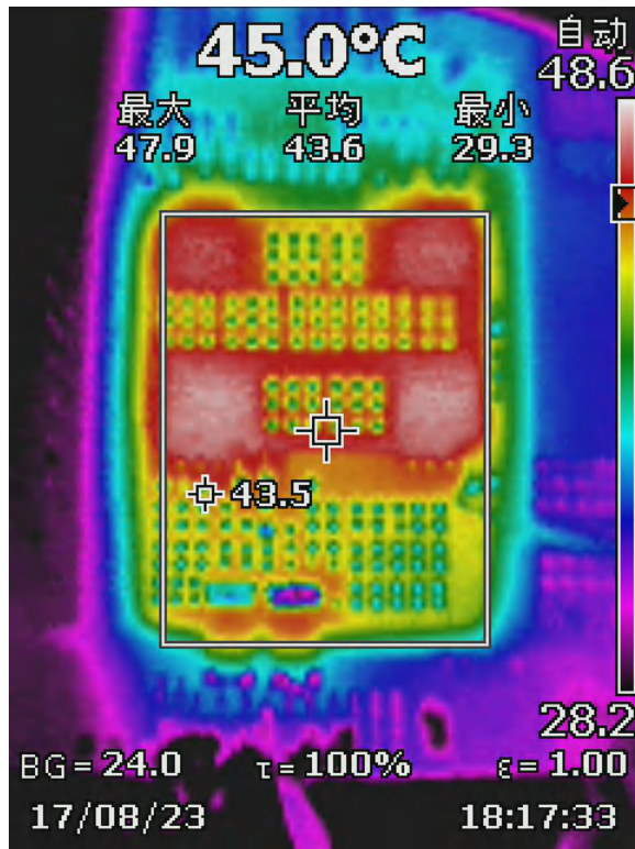
図 4-16. 15A 放電時の熱画像
