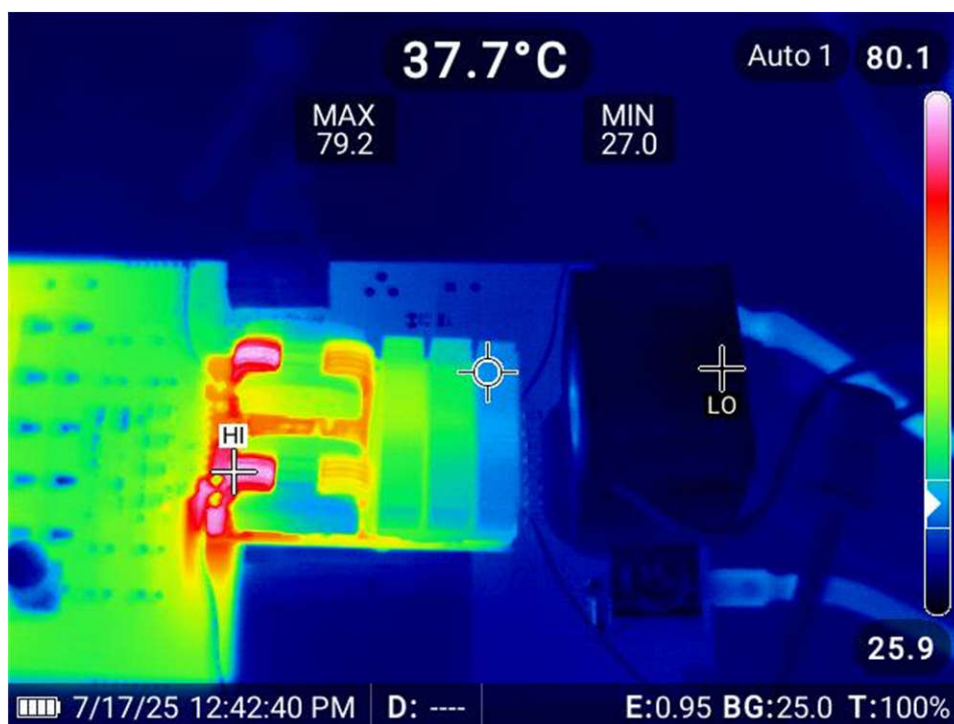
図 3-6. 熱キャプチャ (48V ~ 12V、2kW、周囲温度 25°C、エアフロー 41.2 立方フィート/分)
