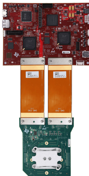
図 1-7. DLPLCRC900DEVM と DLPLCR90EVM を組み立てた状態
