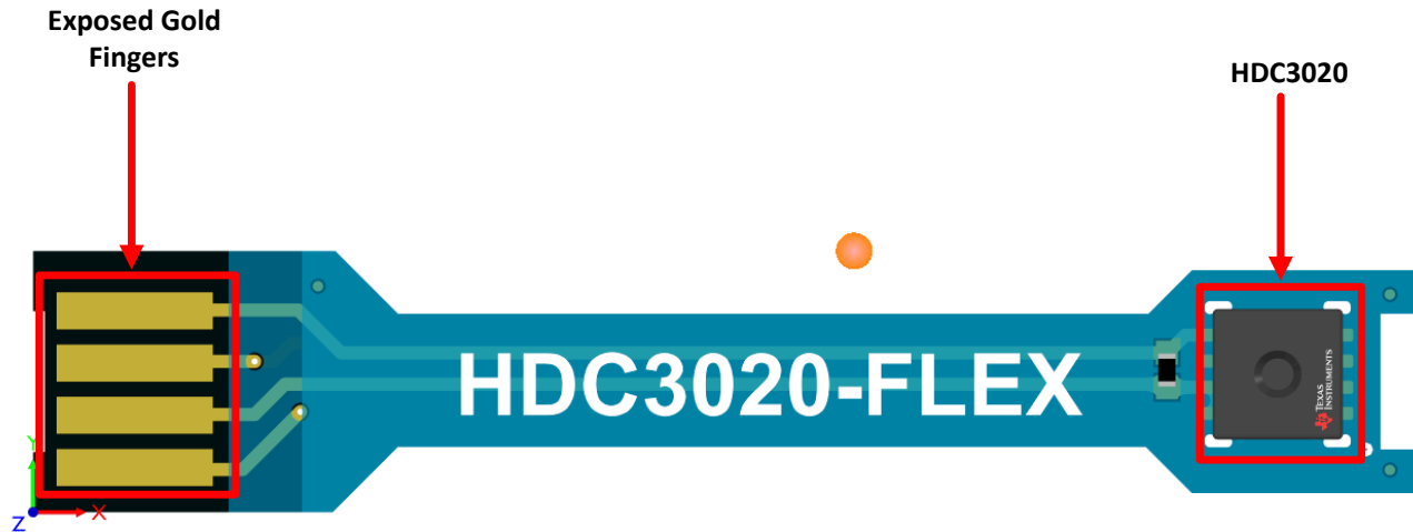
図 1-1. HDC3020FLXEVM 基板セクション
